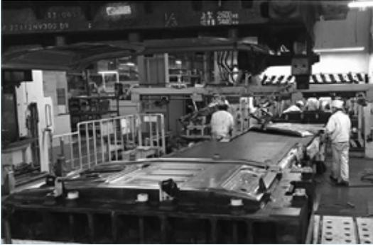
一課長は、「シート内側をさらにビニールで覆いましたが破れやすく、良い素材がないかと探した結果、自動車カバーによく用いられる不織布が最適とわかり採用しています」と試行錯誤の跡を振り返る。また、プレス加工中に発生するちりやごみについては、プレス機械の周囲を粘着性の高いシートで囲うことで金型への付着を防止。さらに、工場内で用いるフォークリフトも、ちりやごみを巻き上げる原因となる排気ガスを出さない電動のものに変更した。ほかにもできる対策は徹底したといい、「現状も試行錯誤は続いています。金型のごみの問題はかなり改善され、歩留りも向上しました」と坂本課長は話す。
